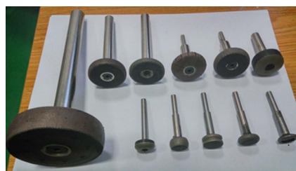
图2 不同结构的超硬磨料柔性抛光轮
